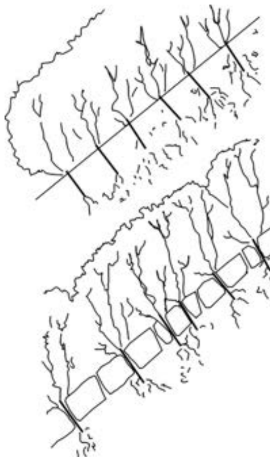
Rys. 65. Skarpa umocniona zrzezami wierzbowymi: a) na skarpie, b) w szczelinach bruku układanego na sucho [Begemann i Schiechl 1999]
