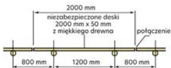
Rys. 74. Schemat deskowania krawędzi brzegu [Krukowski 2006]
