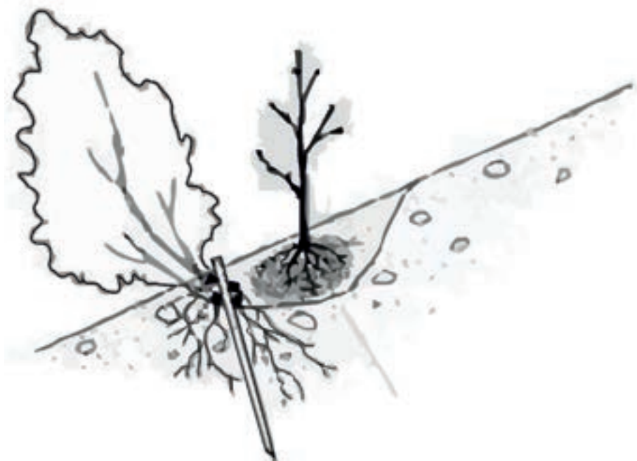
Rys. 68. Umocnienie żłobkowe [Begemann i Schiechl 1999]
