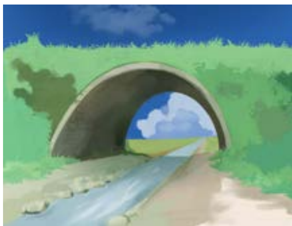
Rys. 87. Przepust/most z naturalnym dnem [Przybyła 2002, zmieniony]
